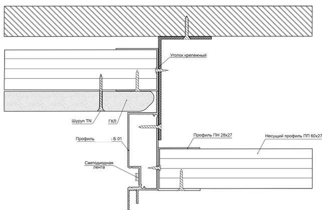
Установите профиль Б 01, затем установите каркас нижнего уровня с учётом количества слоёв и толщины гипсокартона. Если нужно, установите и подключите светодиодную ленту.
