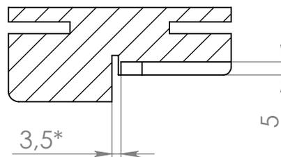
\* Размер ставится с учетом типа устанавливаемого уплотнителя.
